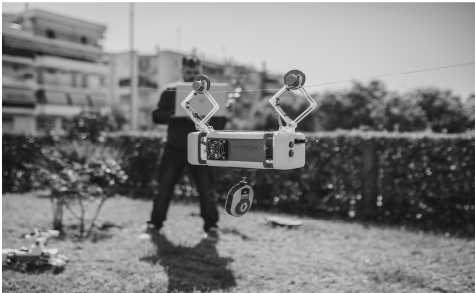
Εικ. 2. Το πρωτότυπο cablebot (test caste) KYTION Aeir που δοκιμάζεται
