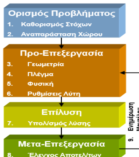
Εικόνα 4-1: Λογικό διάγραμμα μεθόδων CFD για την επίλυση ροϊκών προβλημάτων. [15]
