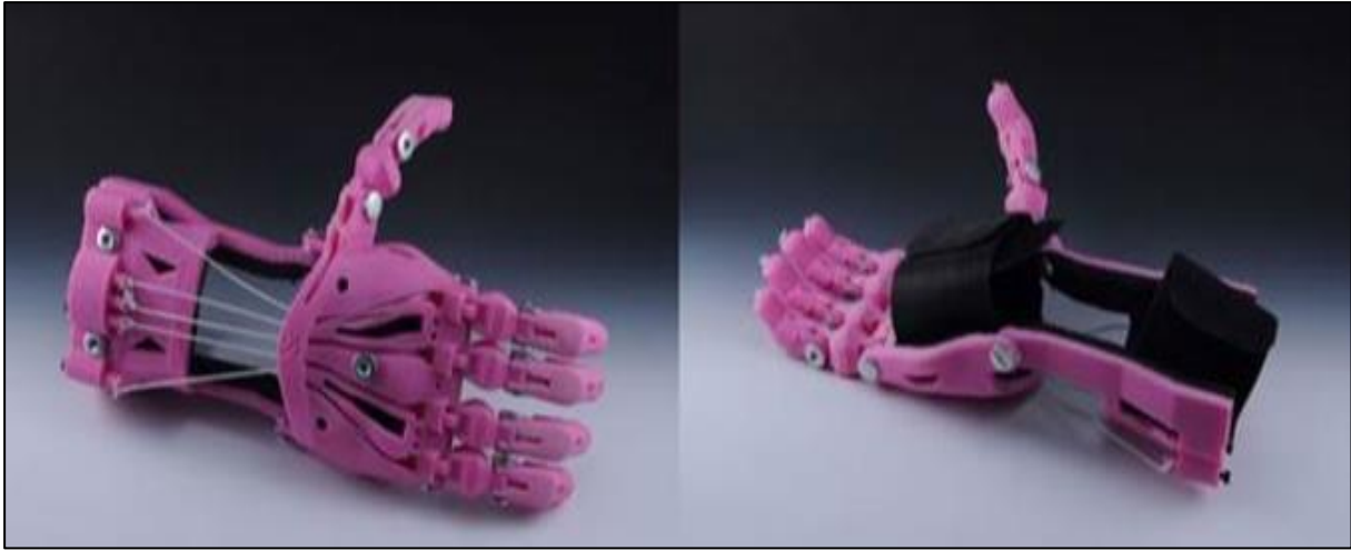
Εικόνα 3.2.23: Cyborgbeast , ένα 3D εκτυπωμένο χέρι για παιδιά ( e-NABLE ). (Πηγή: http://enablingthefuture.org/current-design-files/cyborg-beast-hand/ 3/10/2020)
