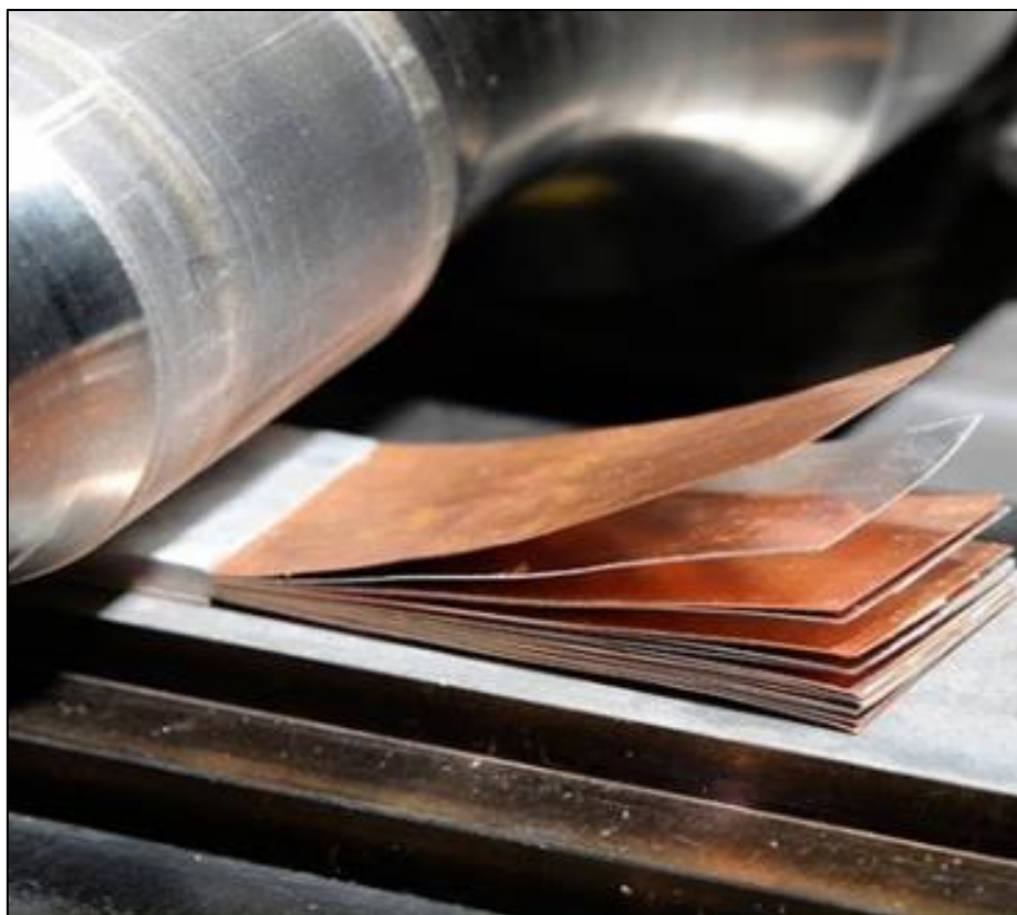
Εικόνα 2.7: LOM (Laminated Object Manufacturing) Κατασκευή από συγκολλημένα φύλλα αντικειμένου
