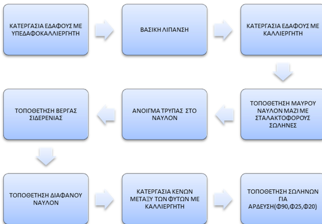
Σχήμα 2.1: Βήματα διαδικασίας ολοκληρωμένης φύτευσης, για φυτό καρπουζιού
