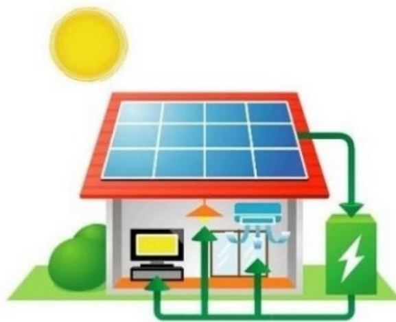
Εικόνα 5: Μη διασυνδεδεμένο φ/β σύστημα (SmartCover, 2020).
