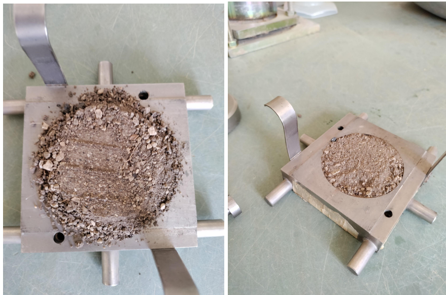
φωτογραφίες δείγματος σε κουτί διάτμησης μετά την ολοκλήρωση της δοκιμής από το εργαστήριο εδαφομηχανικής Πανεπιστημίου Πελοποννήσου
