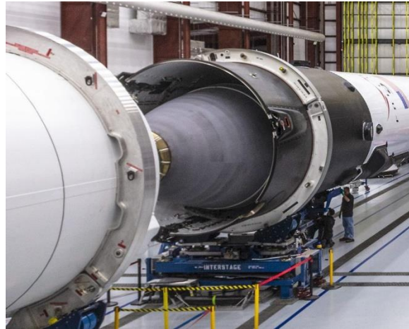
Εικόνα 13: Κινητήρας Merlin 1D με ακροφύσιο ατμόσφαιρας και ακροφύσιο κενού. {EverydayAstronaut}
