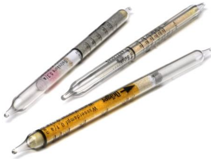
ΕΙΚΟΝΑ 3.2 - ΣΩΛΗΝΙΣΚΟΙ ΑΝΙΧΝΕΥΣΗΣ ΑΕΡΙΩΝ
