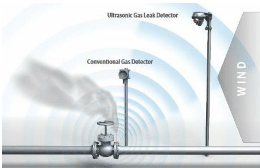
ΕΙΚΟΝΑ 3.10 - ΑΝΙΧΝΕΥΣΗ ΔΙΑΡΡΟΗΣ ΣΕ ΑΝΟΙΧΤΟ ΠΕΡΙΒΑΛΛΟΝ
