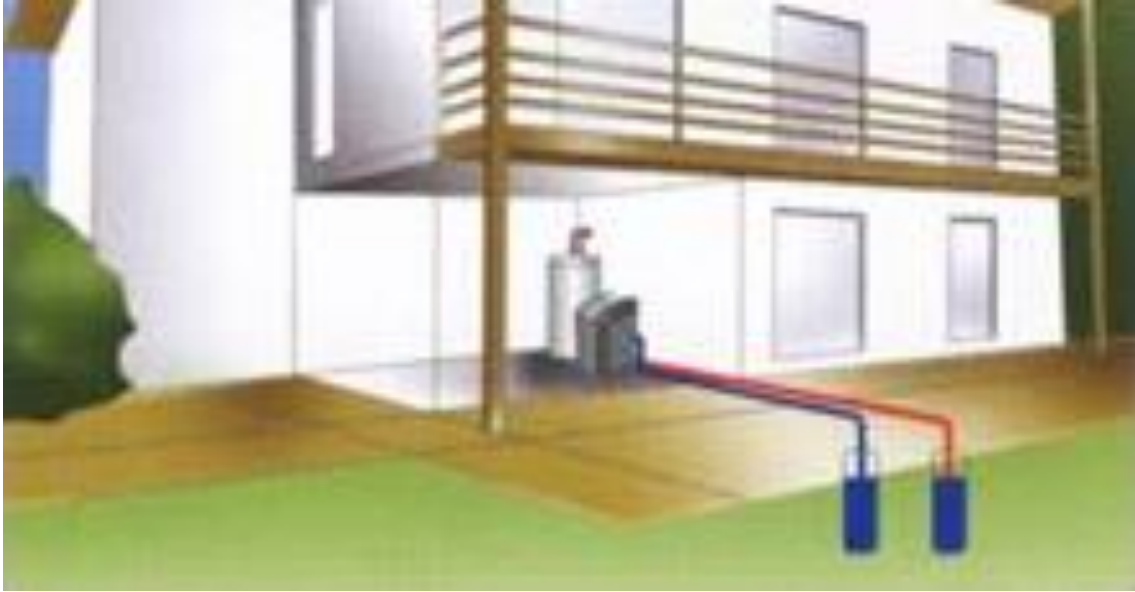
Εικόνα 3-5 Ανοικτό Κύκλωμα :Αντλούμε νερό από τον υδροφόρο ορίζοντα το οποίο κυκλοφορεί μέσω της Αντλίας Θερμότητας, χαρίζοντάς μας θέρμανση ή ψύξη και το επιστρέφουμε στον υδροφόρο ορίζοντα μέσω της δεύτερης γεώτρησης.
