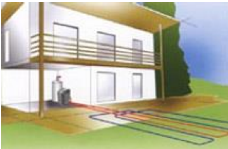
Εικόνα 3-3 Κλειστό Κύκλωμα Οριζόντιου Τύπου: Συνεχής κυκλοφορία νερού και ψυκτικού υγρού μέσω κλειστού κυκλώματος πλαστικών σωληνών που βρίσκονται οριζόντια εγκατεστημένοι σε βάθος 1,5 m περίπου κάτω από την επιφάνεια της γης.
