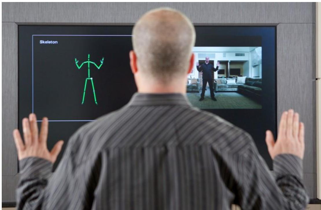
Εικόνα 8. προβολή των κινήσεων μας στην οθόνη με τη βοήθεια του Microsoft Kinect
