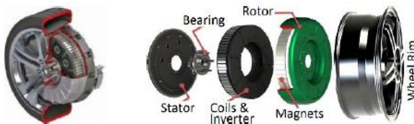
Σχήμα 1.5 Διάταξη κινητήρα στον τροχό [1].
