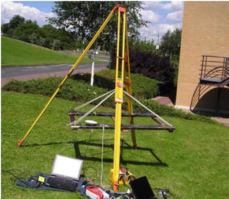
Εικόνα 26 - Πλατφόρμα για τη δυναμική δοκιμή (Πηγή: Yi Ting-Hua, et al. 2016).
