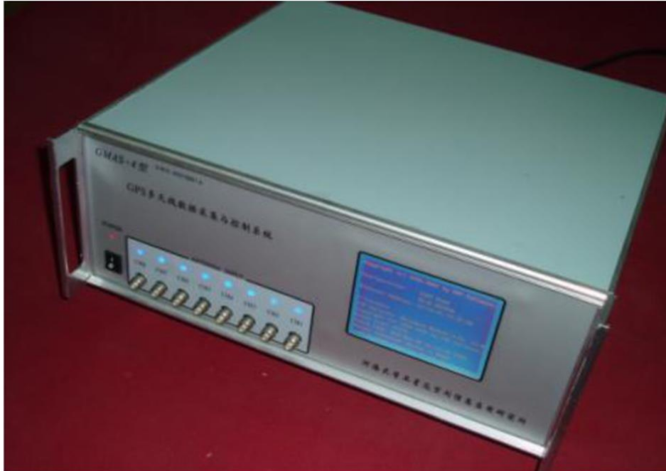
Εικόνα 38 - Συσκευή μεταγωγής πολλαπλών κεραιών GNSS (Πηγή: Yi Ting-Hua, et al. 2016).
