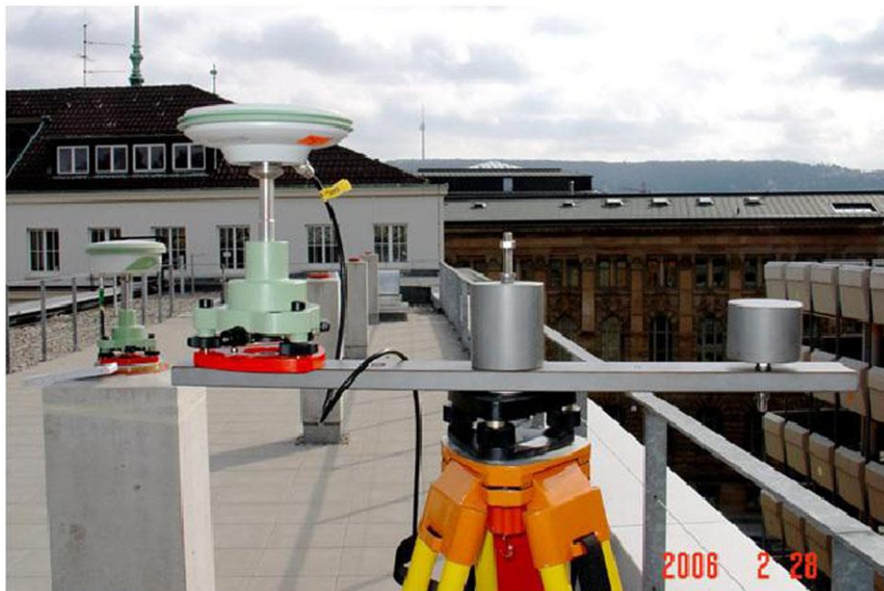
Εικόνα 31 - Κεραία Rover τοποθετημένη σε τρίποδο εφοδιασμένο με περιστρεφόμενο βραχίονα (Πηγή: Yi Ting-Hua, et al. 2016).
