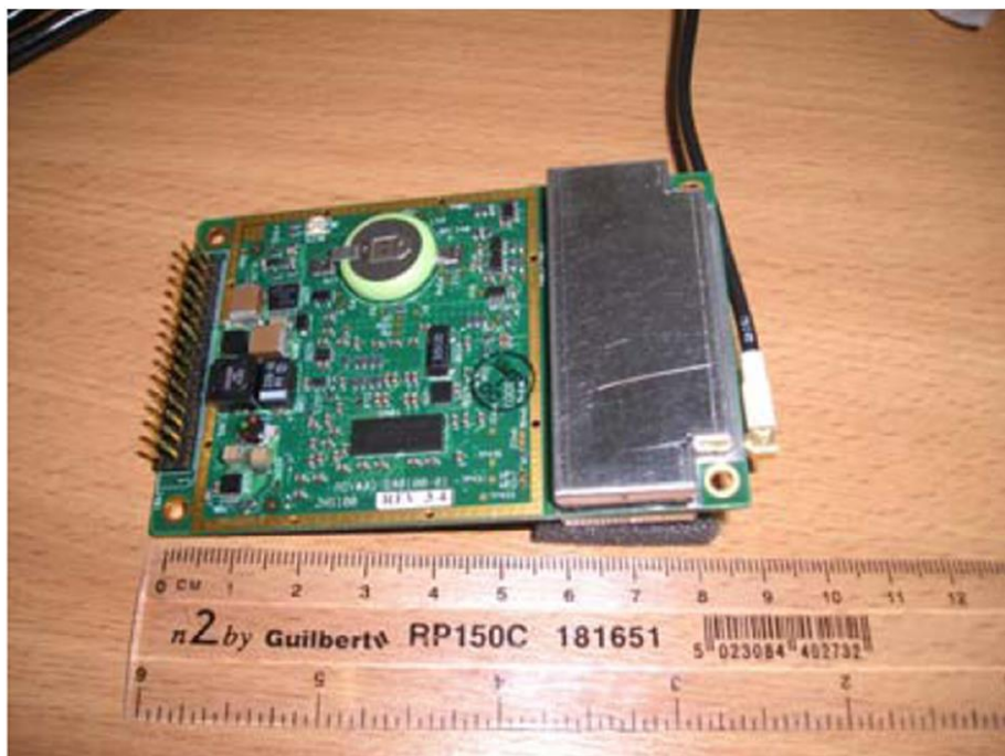
Εικόνα 25 - Ο δέκτης GNSS της πλακέτας JNS100 OEM (Πηγή: Yi Ting-Hua, et al. 2016).
