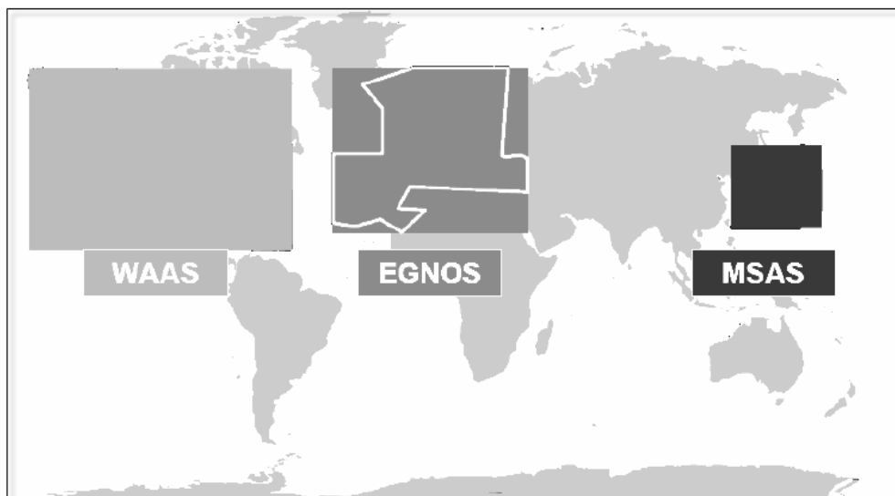
Εικόνα 12 - Αποτύπωμα των Υπηρεσιών Παγκόσμιων Διορθώσεων Διόρθωσης του GNSS: ΗΠΑ (WAAS), Η.Π.Α. (EGNOS) και Ιάπωνες (MSAS)
