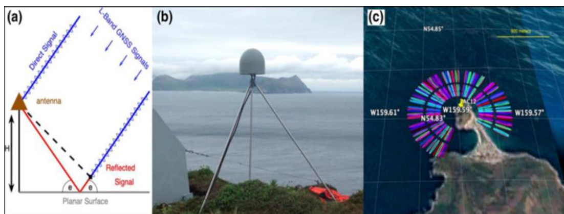
Εικόνα 15 - (α) Αναπαράσταση της λήψης του σήματος GNSS. Η είναι η κατακόρυφη απόσταση μεταξύ του κέντρου της κεραίας GNSS και της ανακλούμενης επιφάνειας και e είναι η γωνία μεταξύ του δορυφόρου και του οριζοντα. Τα απευθείας σήματα GNSS εμφανίζονται με μπλε χρώμα και η πρόσθετη διαδρομή που διανύει το ανακλώμενο σήμα εμφανίζεται με κόκκινο. (β) Δέκτης GNSS AC12 στο νησί Chernabura, Αλάσκα (Φωτογραφία: UNAVCO). (γ) Οι ζώνες ανάκλασης που εμφανίζονται με χρώμα χρησιμοποιήθηκαν για τις μετρήσεις της στάθμης του νερού AC12 (Roesler & Larson, 2018). Ο χάρτης είναι ευγενική προσφορά του Google Earth (Πηγή: Larson, K. M., et al. 2021).
