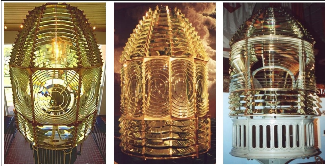
Εικόνα 19: Φακοί Fresnel 1 ης , 2 ης και 3 ης τάξης (από αριστερά προς δεξιά) [28]
